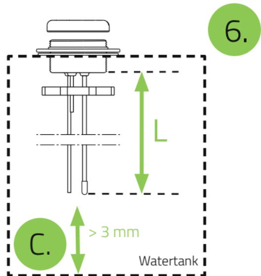
**NL** Optioneel: kort de twee lange pinnen in met een ijzerzaag (A). Schuif de meegeleverde dop over de pin met de kunststof bescherm laag (B). Minimale afstand tot de tankbodem is 3 mm (C). Meet en noteer de nieuwe lengte van de pinnen (L).
